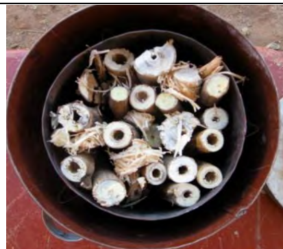
Un Campeón de Uganda, con una carga de palitos de bambú verticales (Foto: Christoph Messinger)
