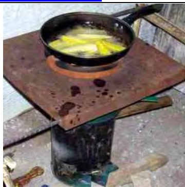
Un Campeón realizado en Mozambique con un soporte de olla fijo
